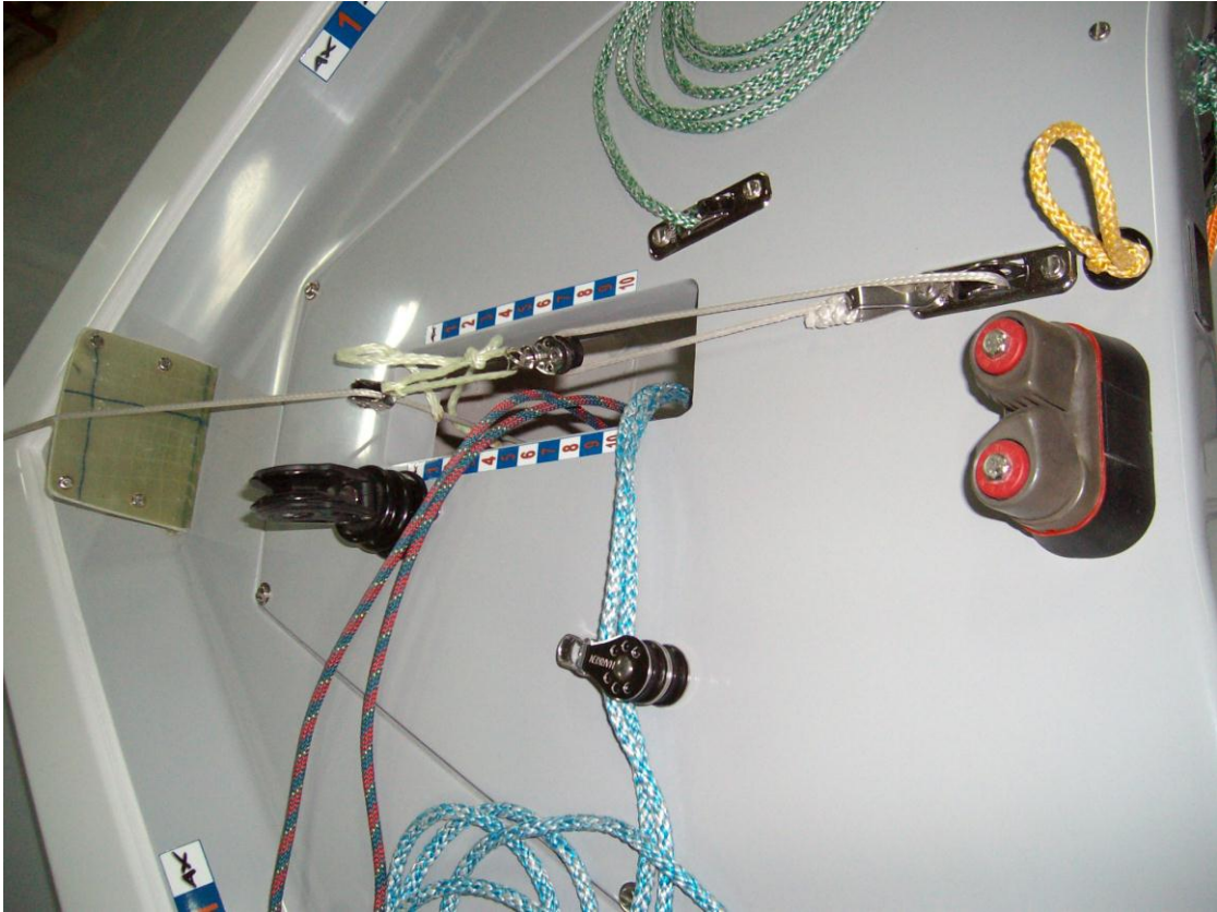
Ilustración 9. Fogonadura, Polea y mordaza control tangón
