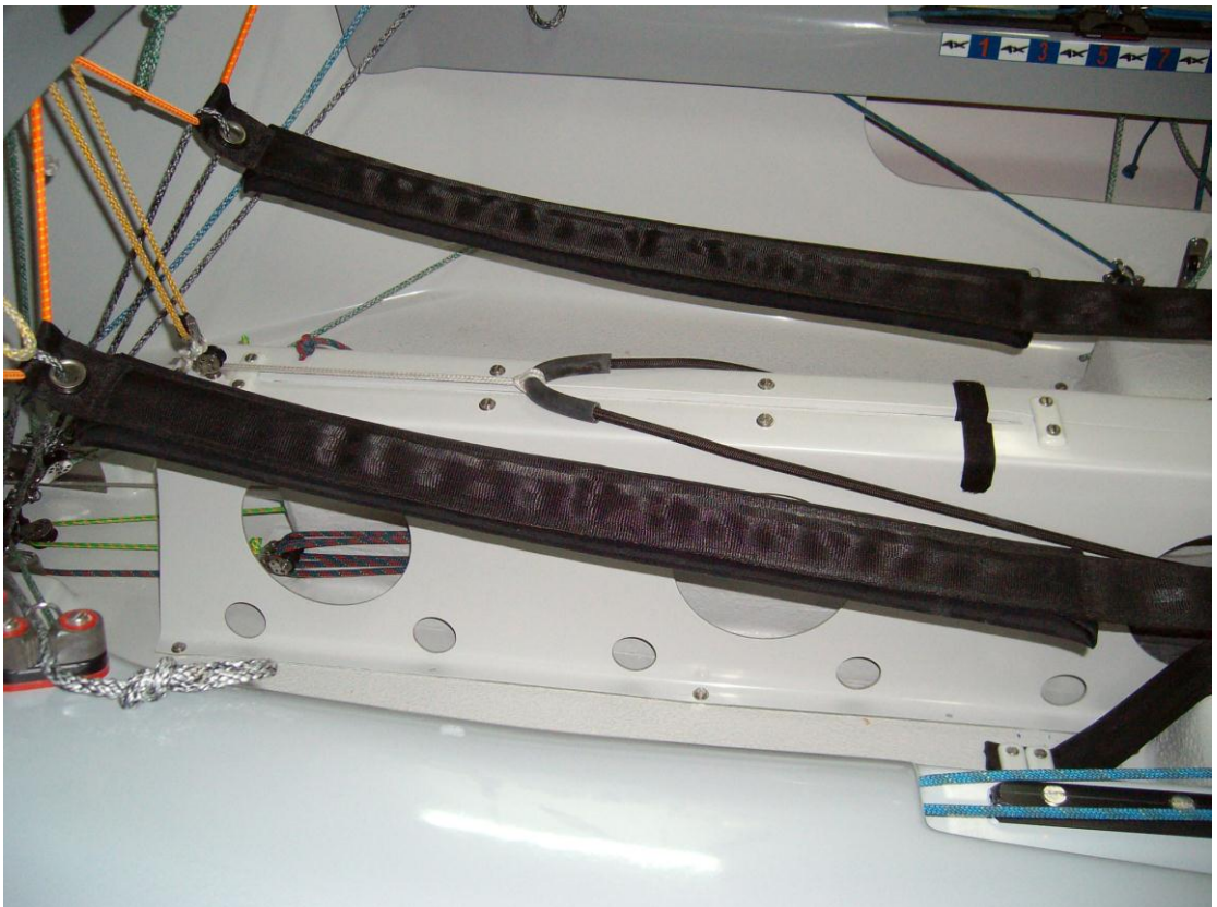
Ilustración 10. Detalle cajera y retención de la orza
