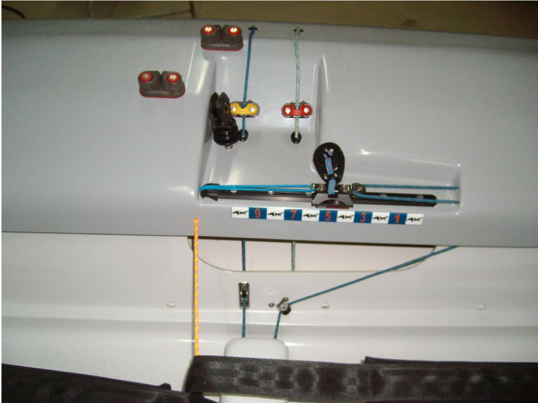
Ilustración 1. Escotero del Foque sobre patines a bolas Harken regulable desde la banda (mordaza roja). La mordaza amarilla es control del palo a proa.
