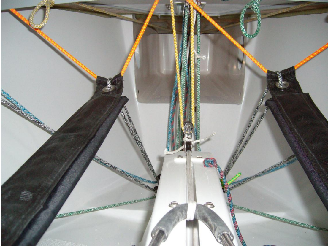
Ilustración 3. Alojamiento bajo la cubierta de proa para facilitar el transporte de velas y botavara
